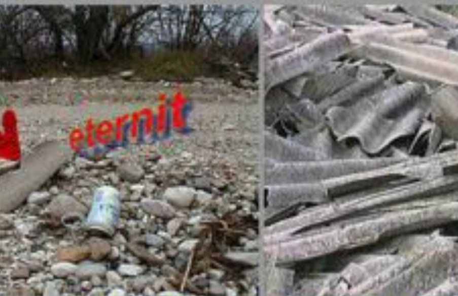
Piazzi di coperture in eternit, materiale contenente cemento e amianto, sono state scattate sul greto del Tormenta-Covera e del Cellina durante lo svolgimento
